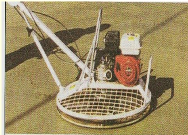
Vyhlazení křídlovou hladíčkou
